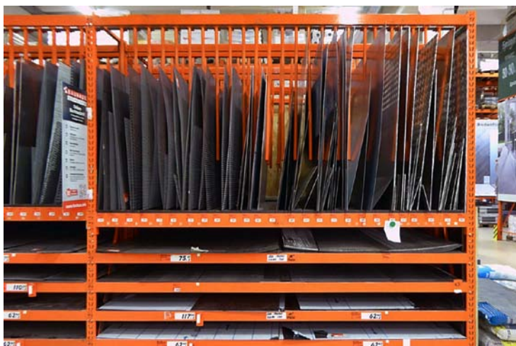
Sklad na tabule plechu s pevně namontovanými dělicími lištami
