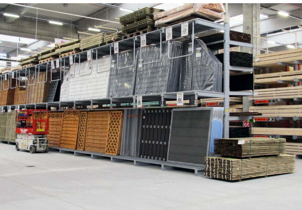
Regál s ochranným obloukem proti převrácení (nahore) a vodicími lištami pro pohyblivý žebřík (spodní úroveň)
