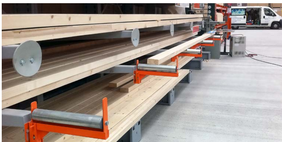
Regál pro truhlárny s vestavěnou válečkovou dráhou
