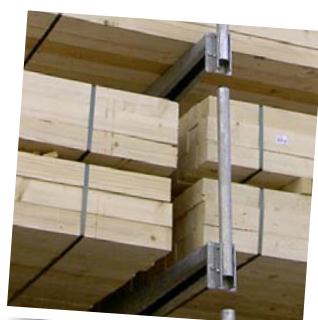
Zábrana proti pohybu (50 cm), jednoduchá manipulace jednoduchým vyklopením
