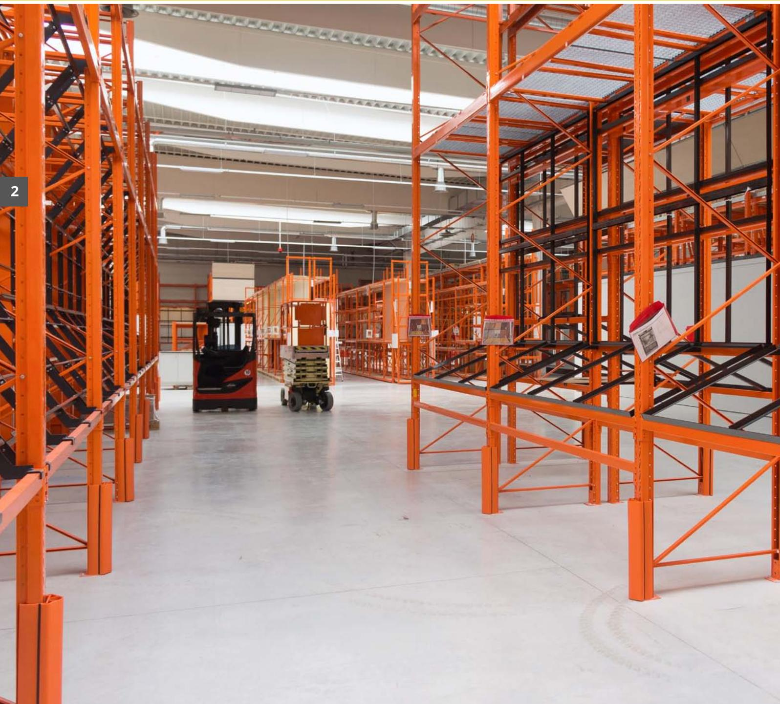
Das mehrfach gefaltete Profilsystem aus 2 bzw. 3 mm starkem Stahlblech bildet die Grundlage des SL100-Systems
