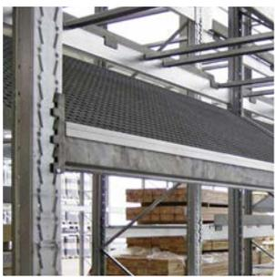
Z-Profil-Schienen mit schrägen Gitterrost-Ablagen
