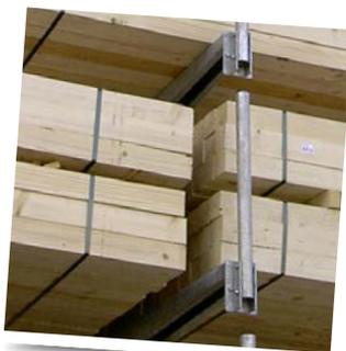
Abrollsperr (50 cm), einfache Handhabung durch Herausklappen
