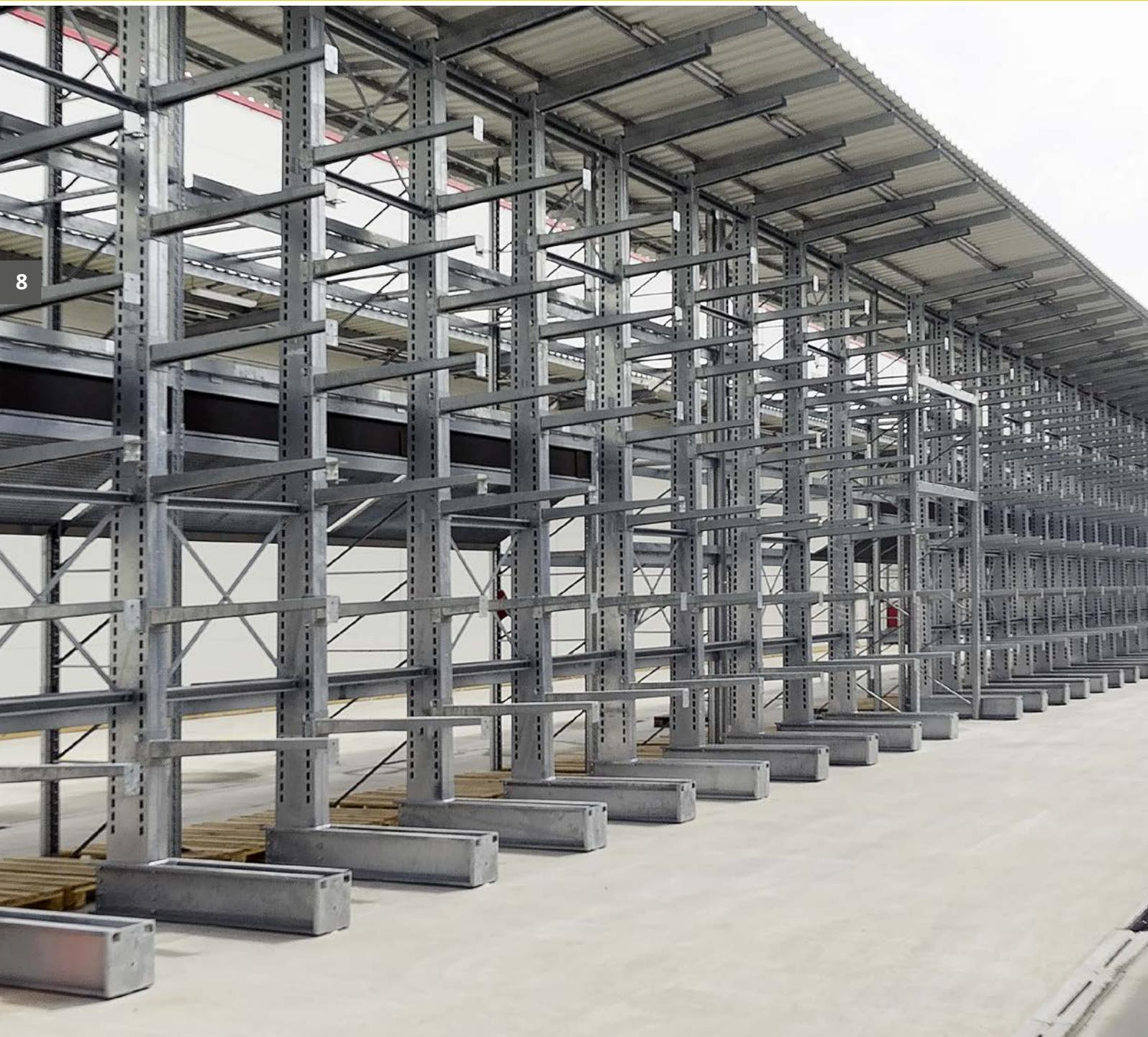
Die Ständer des SF3-Regals bestehen aus 3 mm starkem Stahlblech. In dem 76 mm-Schlitzraster lassen sich die Kragarme nach Bedarf positionieren.
