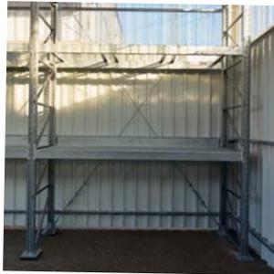
Die Fußplatten werden im Betonboden verschraubt. Unterlegplatten sorgen für Höhenausgleich.
